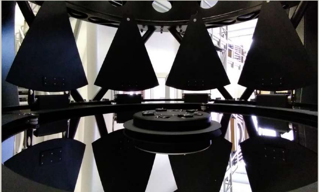
Figura 5. Lo specchio primario da 1 metro di diametro del Wide-field Mufara Telescope. La foto è stata scattata presso i laboratori di Officina Stellare (Sarcedo, VI), durante le fasi di assemblaggio e test dello strumento. Crediti: Officina Stellare e Fondazione GAL Hassin/ Alessandro Nastasi
